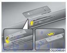
2. Rotate the cover half way and insert the cover on the roof hole as the illustration. تلفن شبانه روزی: ۱۵۸۰۲۰۸۸ – ۲۱
