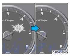
The auto stop indicator ((A)) blinks in green for 5 seconds on the instrument cluster, مرافع المنافع المنافع
